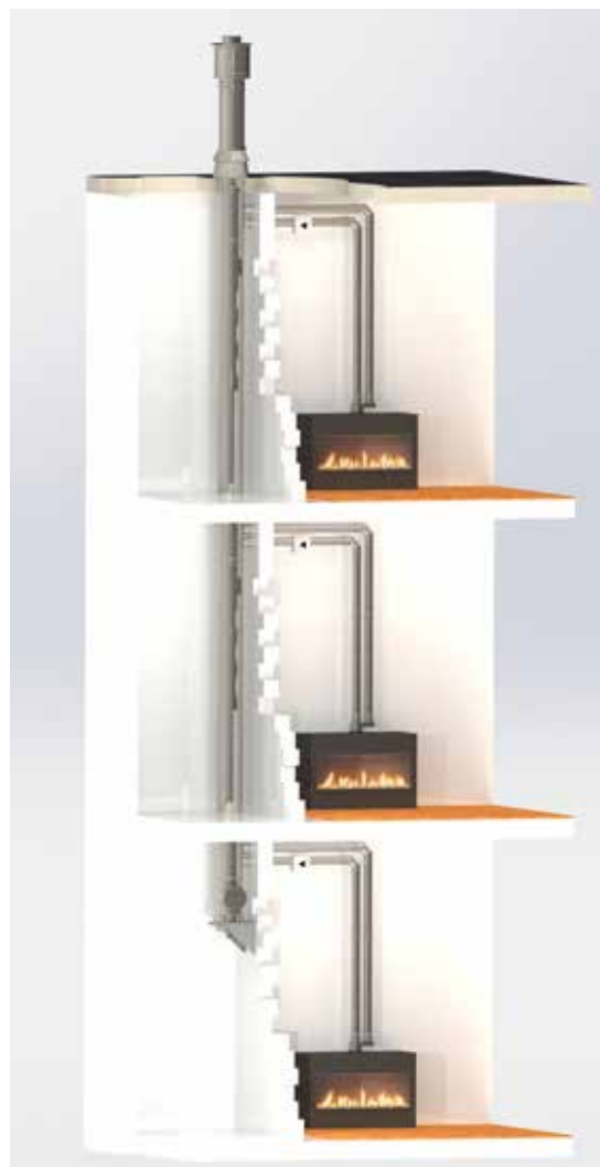
CSG-opstelling in overdruk met parallelle aansluitingen 80/80 en individuele ventilator. ►
