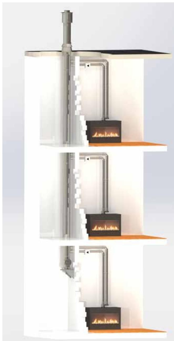
▲ CSG-opstelling in overdruk met parallele aansluitingen 80/80 en individuele ventilator
