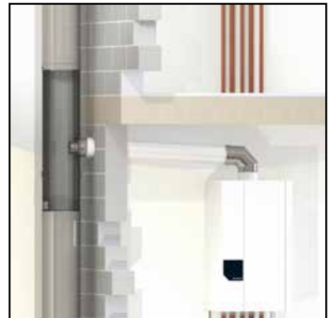
Aansluitement naar de CV-ketel(s)
