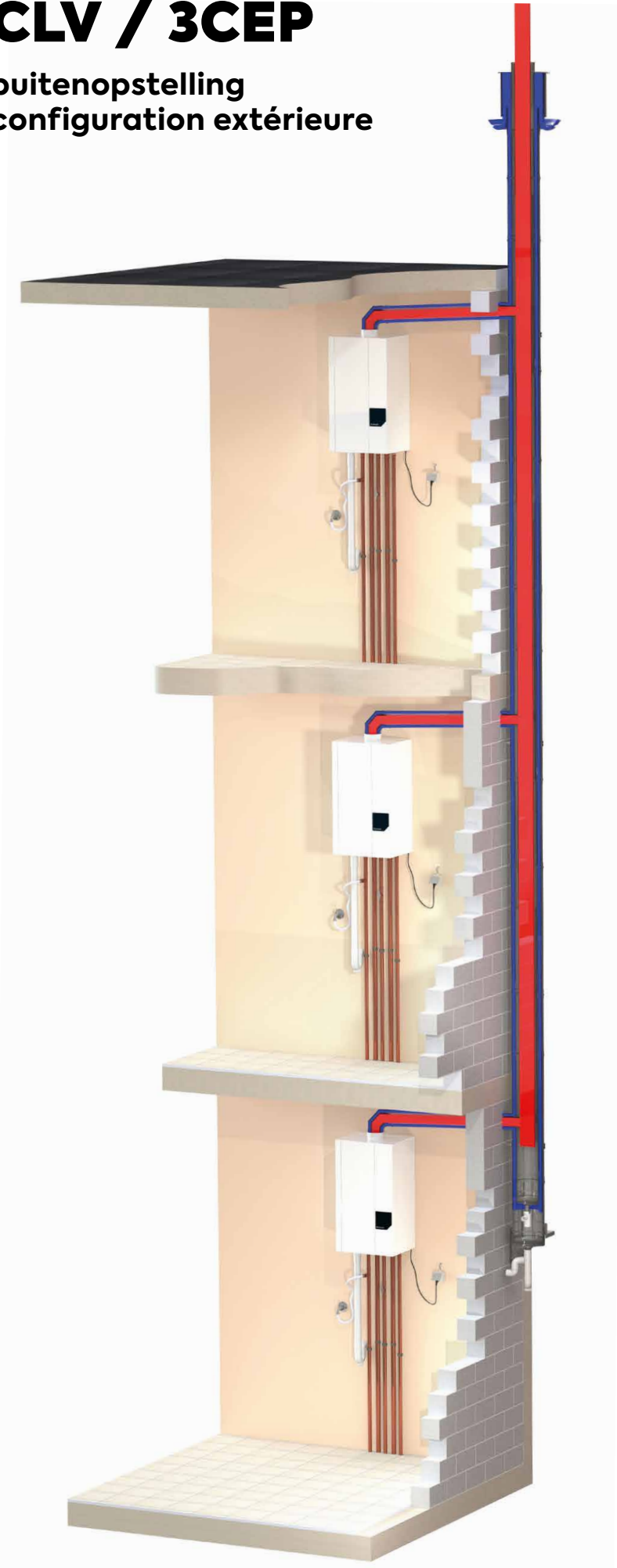
Regelbaar element dat zich aanpast aan iedere verdiepingshoogte
