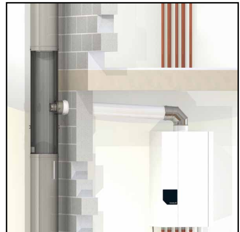
Aansluitement naar de CV-ketel(s)
